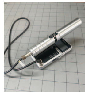
シンチレーション式 サーベイメータ
