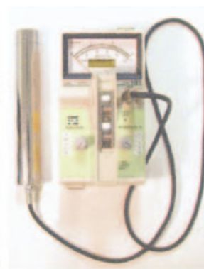
シンチレーション式 サーベイメータ
