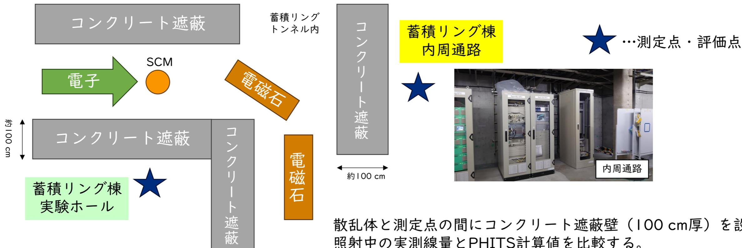
散乱体と測定点の間にコンクリート遮蔽壁（100 cm厚）を設ける。照射中の実測線量とPHITS計算値を比較する。
