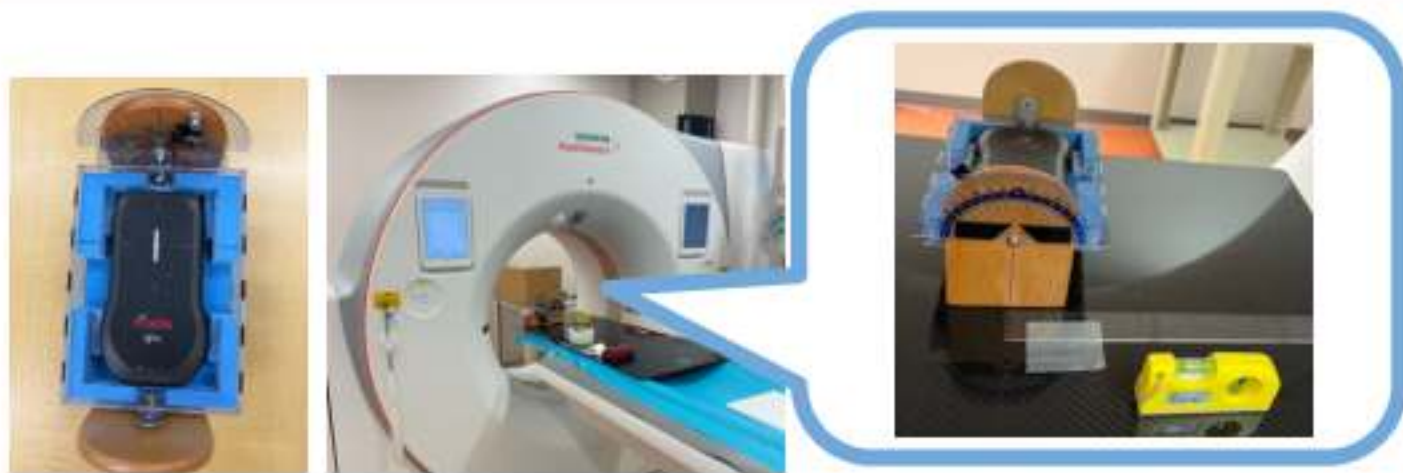
図4 半導体検出器Piranha (RTI社),CT装置NAEOTOM Alpha (Siemens Heltheneer社)および測定体系
