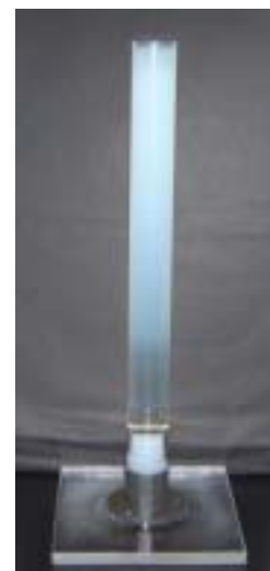
図1 ポリマーゲル線量計 (6MV-X線照射後)
